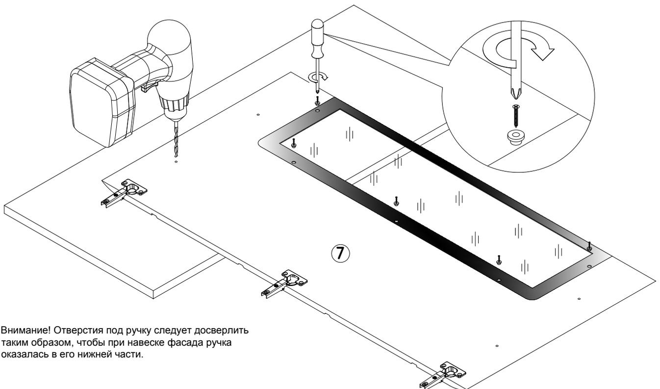
Внимание! Отверстия под ручку следует досверлить таким образом, чтобы при навеске фасада ручка оказалась в его нижней части.
